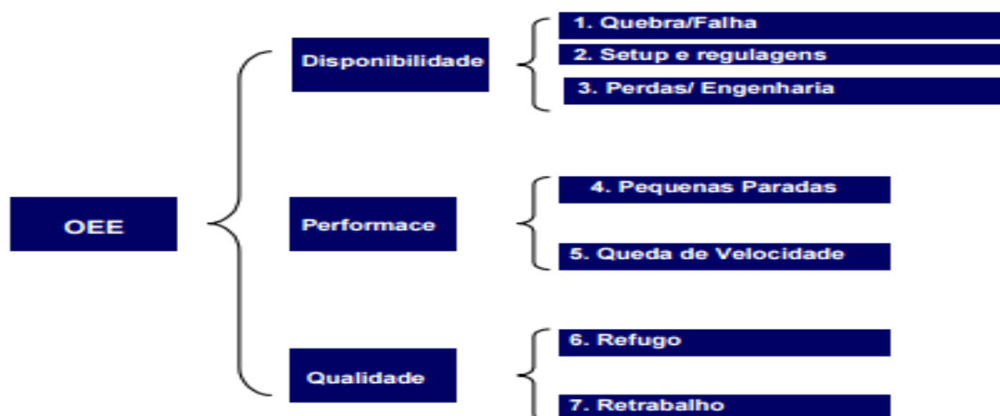
Figura 3 - Elementos da eficiência global de uma máquina - Fonte: (Santos. 2007)
