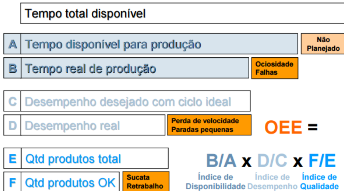
Figura 4 - Elementos da eficiência global de uma máquina - Fonte: (Santos. 2007)
