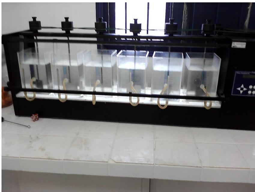
Figura 4. Aparelho Jar-test
