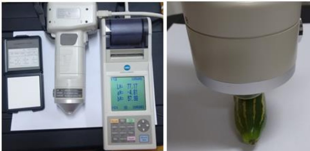
Figura 3 – Equipamento colorímetro Minolta, modelo CR-400, e a realização da análise de cor em pepino selvagem ( Melothria pendula L. ) no estágio 1 de maturação.
